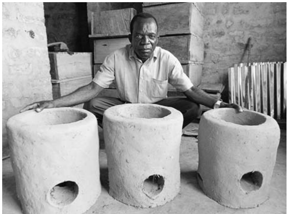
Einführung von Lorena-Öfen zur Reduzierung von Brennholzverbrauch und Atemluftbelastung (Konda KuMbuta)
